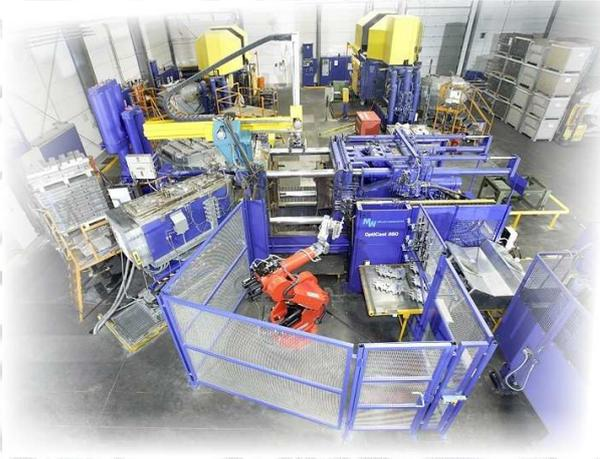
Gießzelle bestehend aus Druckgussmaschine, Schmelzofen, Entnahmeroboter, Förderband und Entgratpresse
