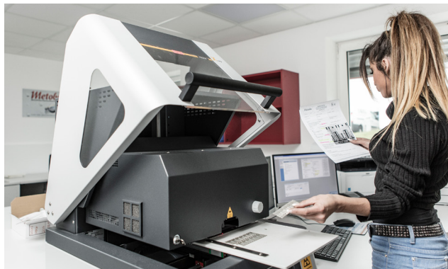
Qualitätssicherung mittels Schichtdickenmessung
