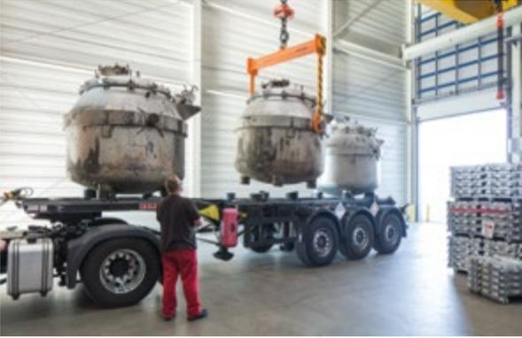
15 Tonnen flüssiges und 760 Grad heißes Aluminium werden mit dem Hallenkran abgeladen.
