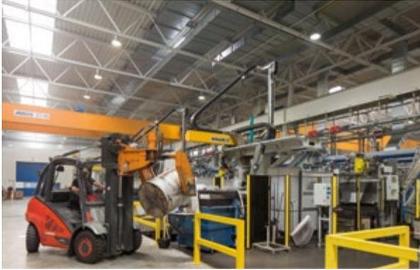
Interne Transporte vom flüssigen Aluminium bis hin zu Fertigteilen ermöglichen einen effizienten Materialfluss. Dabei sind über 70 Stapler im Einsatz.
