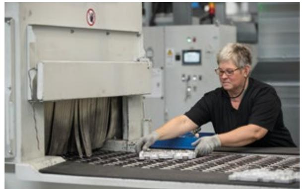
Strahlenanlagen, die bis zu 15.000 Teile am Tag entgraten können.
