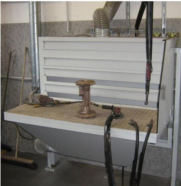
Höhenverstellbarer Arbeitstisch mit Rückwandabsaugung als Schleif- und Schweißstisch, bestehend aus einer stabilen Stahlkonstruktion, geschweißt, lackiert mit Auffangtrichter und Absaugstutzen am Tisch. Der Tisch ist höhenverfahrbar mit elektrischem Spindel- / Zahnstangenantrieb.
