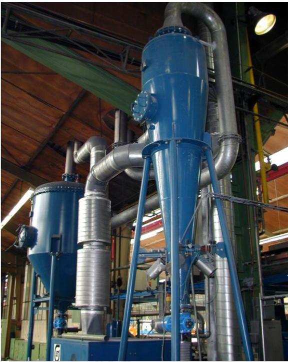
Absaugung und Abscheidung von Stäuben, die beim Flammspritzen frei werden.
