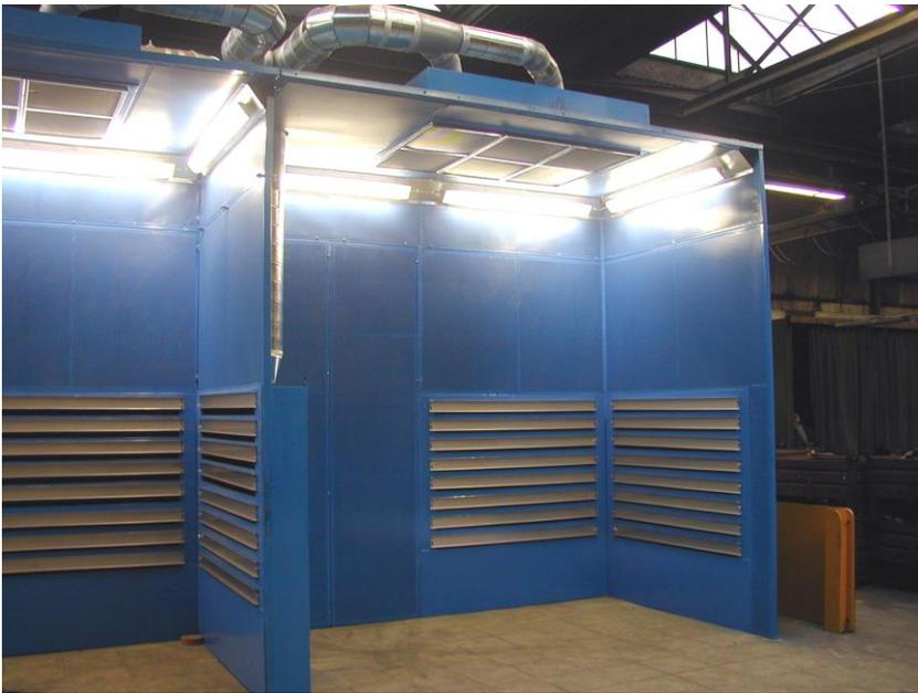
Schleifkabinen zur Bearbeitung geschmiedeter Stahlteile. Die Kabine ist mit einer Zuluftdecke und einer leicht zu demontierenden Absaugwand aus Edelstahl ausgestattet.
