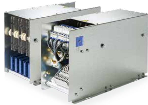
HEUTE Eigensicherer Kombiwiderstand aus Stahlgitterwiderstandselementen und gekapselten Flachwiderständen
