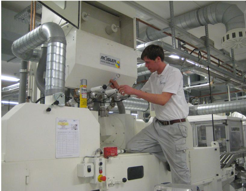
Industriemechaniker/innen sind in Produktion und Instandhaltung tätig, wo sie dafür sorgen, dass Maschinen und Fertigungsanlagen betriebsbereit sind.
