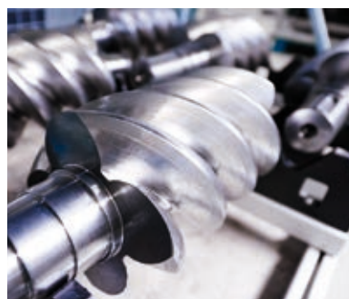
Bei höheren Drücken überlegen: Rotorprofile von Schraubenverdichtern
