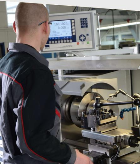
Industriemechaniker sorgen dafür, dass Maschinen und Fertigungsanlagen betriebsbereit sind. Nach Abschluss von Montage und Prüfungsarbeiten weisen sie Kollegen oder Kunden in die Bedienung und Handhabung ein.
